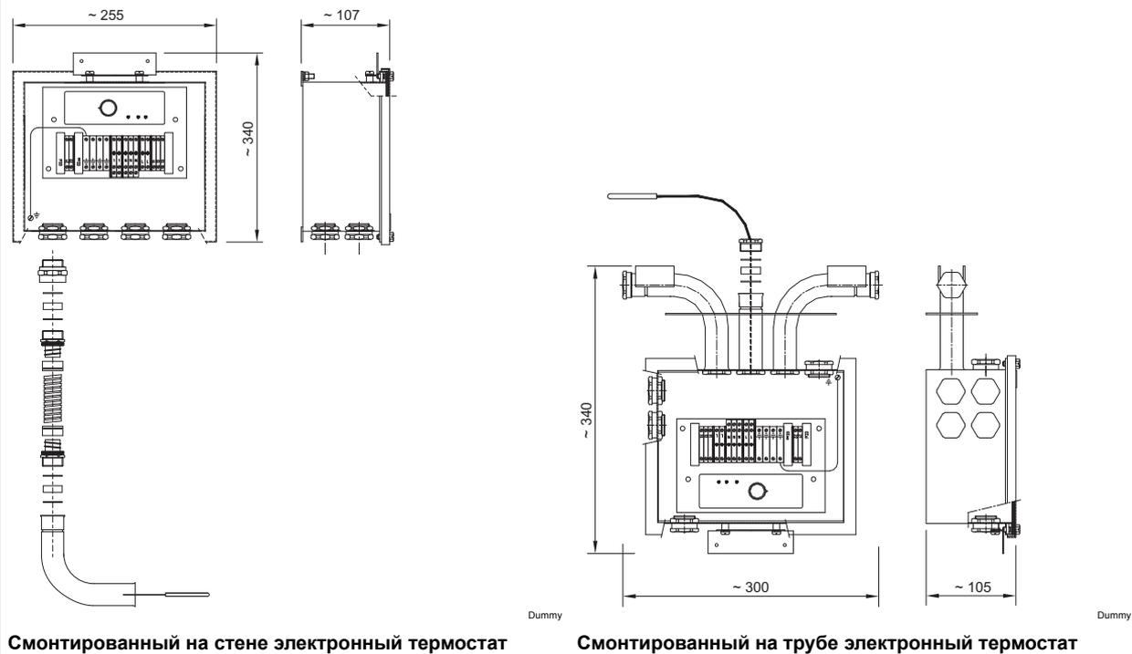
Смонтированный на стене электронный термостат
