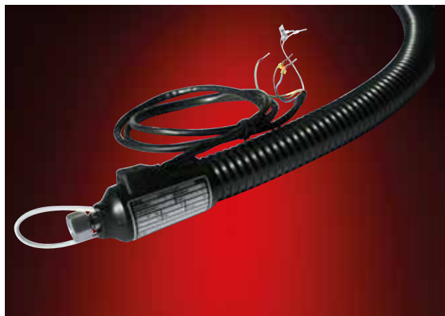
ELH/mdw-200 °C-DN10; Обогреваемый напорный шланг с выступающим нагревательным кабелем для обогрева присоединительной арматуры; Область применения: машиностроение / транспортировка масел и смазок для установки для нанесения покрытий
