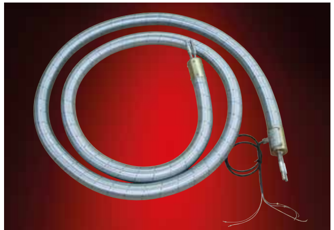
Тип: ELH/2adT-150 °C-УП8/10 Обогреваемый пробоотборный шланг с 2 внутр. каналами УП8/10 с ударопрочным металлическим гофрированным шлангом. Поддерживаемая темп-ра: 150 °C
