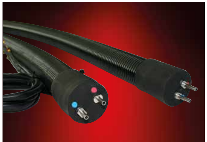
ELH/2aw-200 °C-УП6, обогреваемый пробоотборный шланг с 2 внутренними каналами УП 6/8 из ПФА и двусторонним, беспереходным специальным патрубком RSL. Поддерживаемая температура 200 °C
