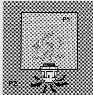
Перепады давления, обусловленные температурой между внутренней полостью корпуса (P1) и окружающей средой (P2) надежно компенсируются климатическим штуцером. Благодаря этому сводится к минимуму образование конденсата в корпусе.
