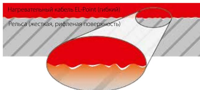
Благодаря своей гибкости и мягкости поверхности EL-Point выравнивает большую часть неровностей. В результате обеспечивается очень хорошая теплопередача рельсу, что приводит к достижению более высоких температур с меньшими затратами энергии.
